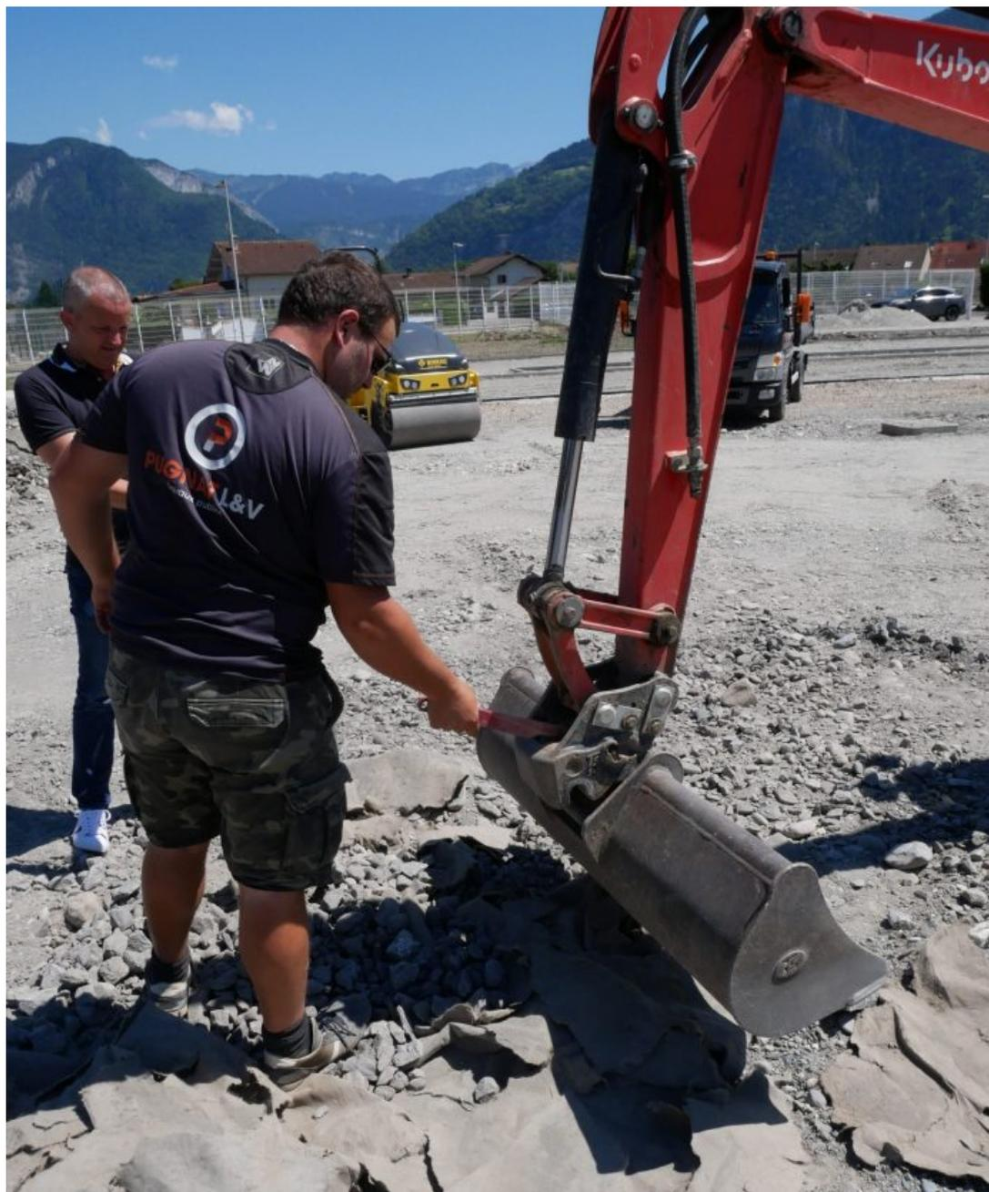
*Didier Cinquin, d'ACB Pume checke en direct le bon fonctionnement du déverrouillage à la clé de son coupleur Trigger TS1-S nouvelle génération. L'opération est réalisée par le chauffeur de la pelle qui n'a qu'une fois à descendre de sa cabine. Le verrouillage étant automatique.*
