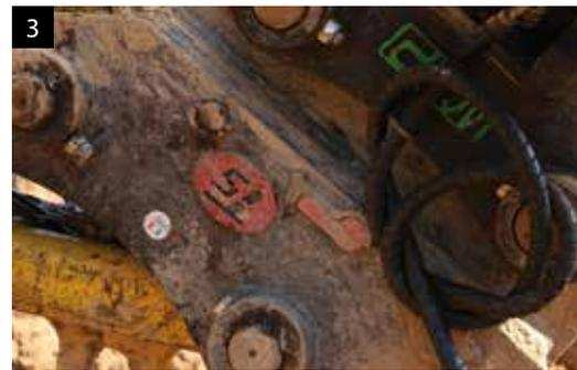
**1/ L'opération de verrouillage-déverrouillage est hydraulique et la sécurisation est automatique, opérée depuis sa cabine par le chauffeur qui suit un processus très simple d'enclenchement • 2/ La sécurité se met en place immédiatement dans le process de verrouillage ! • 3/ Le témoin de verrouillage permet de vérifier que la sécurité du système est bien en place ou qu'il est en attente d'accrochage.**
