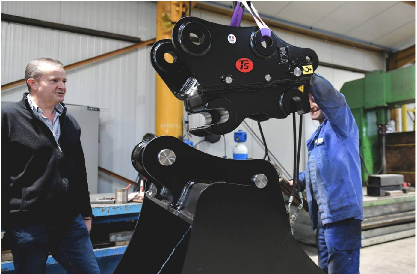
Les attaches rapides d'ACB Pume permettent de positionner les godets de façon à creuser ou à remblayer. Photo Florian Salesse
